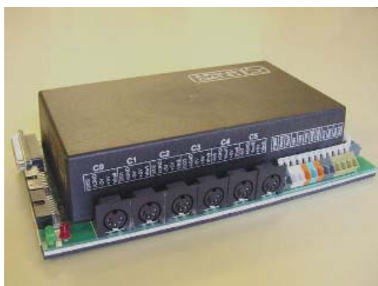
Obr. 7.2 Měřicí panel systému CMC – S3
