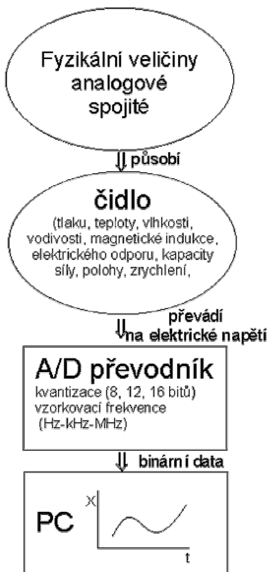
Obr. 7.1 Schéma měření pomocí počítače
